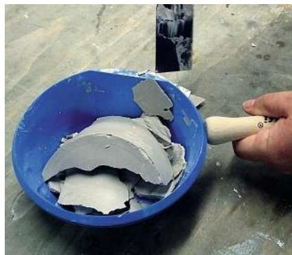
**Bild 5b:** ... der sich nach dem Festwerden leicht herausdrücken lässt ...
