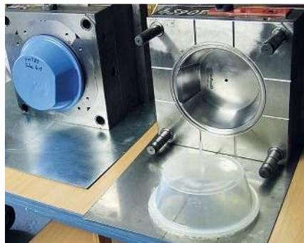
**Bild 3:** Ausgangspunkt des Vakuumspitzverfahrens ist die Form aus Werkzeugstahl – hier als Demonstrationsobjekt
