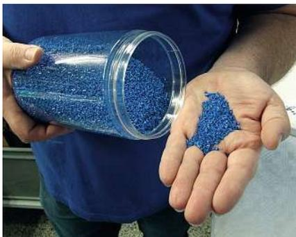
**Bild 2:** Die blauen Granulatzusätze für die Einfärbung des sonst farblosen Kunststoffs
